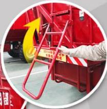
作为一款高端机型，勇猛4YZ-4A的果穗箱设计，在人性化元素方面无不释放着让用户心动的创意，比如：折叠式扶梯，方便攀爬与收藏；卸粮口活动导板设计，有30°可调范围，在卸粮时能够提高果穗下落速度，行驶时恢复原位，不影响作业的进行。
