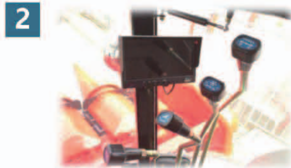
驾驶室内液压控制滚筒无级变速，省时、省力
