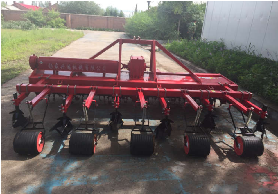
SGTN-330 型旋耕联合整地机
