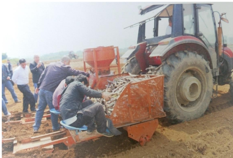
切断式甘蔗播种机，生产率 2.5 亩/小时
