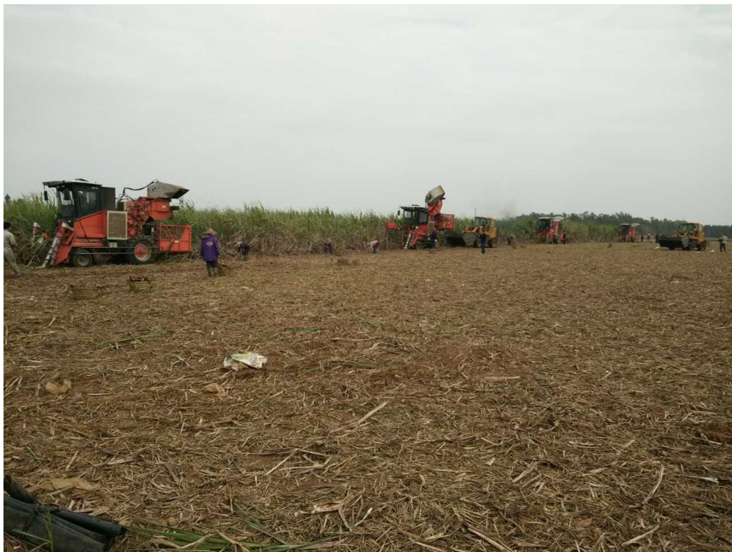
中型切段式甘蔗联合收割作业（生产率 5-8 吨/小时）
