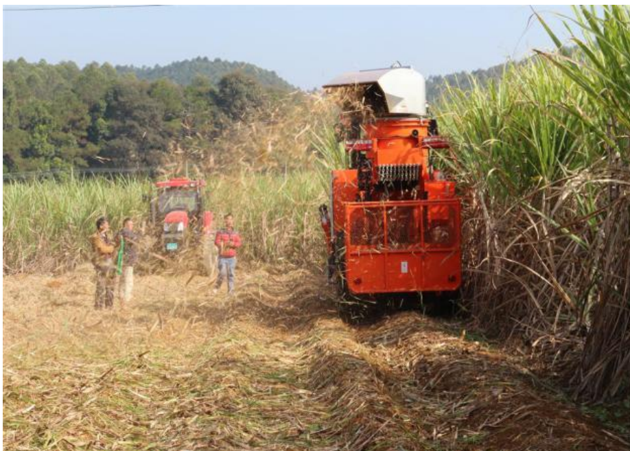
中型切段式甘蔗联合收割作业（生产率 5-8 吨/小时）
