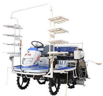
带侧深施肥的乘坐式高速插秧机
