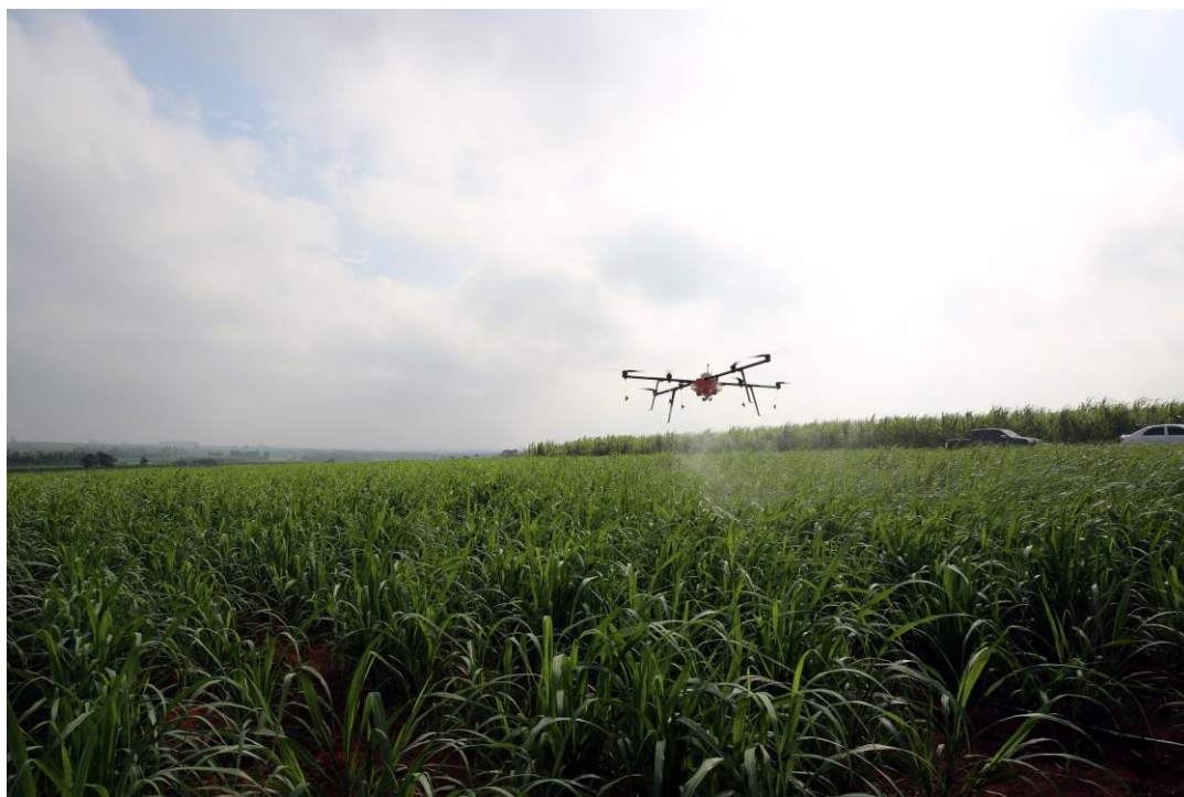
机械化植保（农用无人机工作效率可达 50-80 亩/小时，用于甘蔗长高之后的植保作业具有传统植保方式无法替代的作用，是绿色环保的植保作业模式。）
