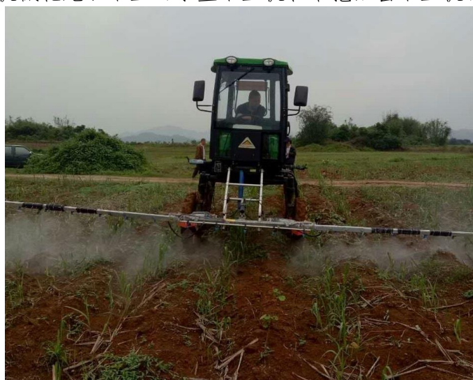
机械化植保（喷杆喷雾机工作效率 6-7 亩/小时）
